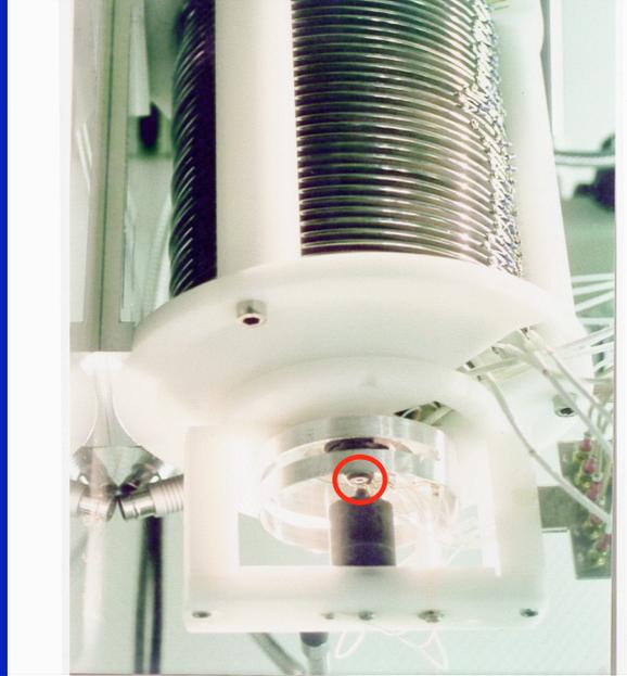
IL VOLUME DI RACCOLTA DEGLI ELETTRONI ha dimensioni di circa 4mm, a 3 mbar di propano equivale a 25nm d'acqua
